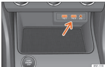
Fig. 247 Centre console: USB/AUX-IN input.
