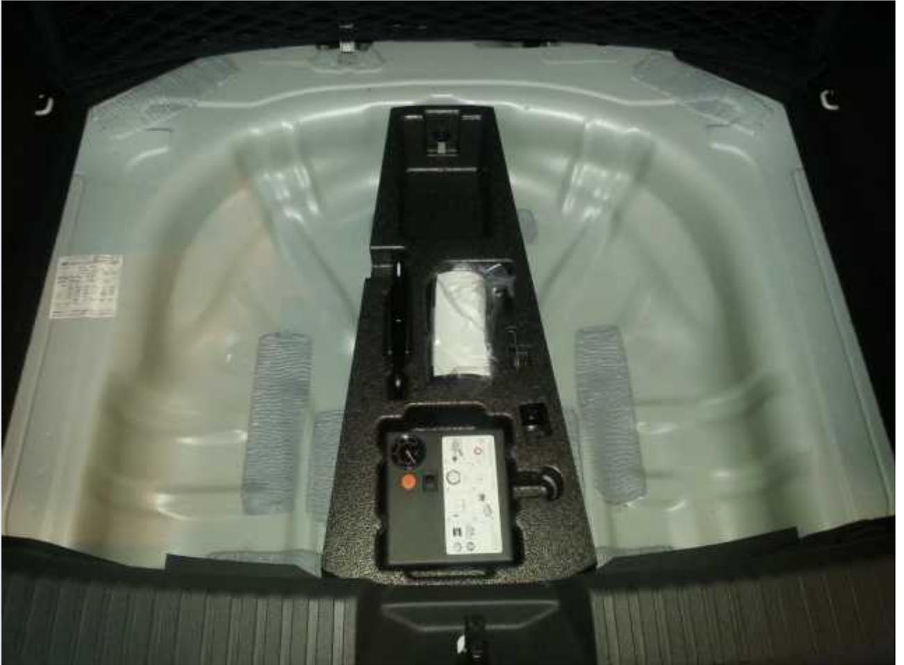
sustituimos la espuma que llevo por la espuma acondicionada para albergar el subwoofer y el kit reparapinchazos :
